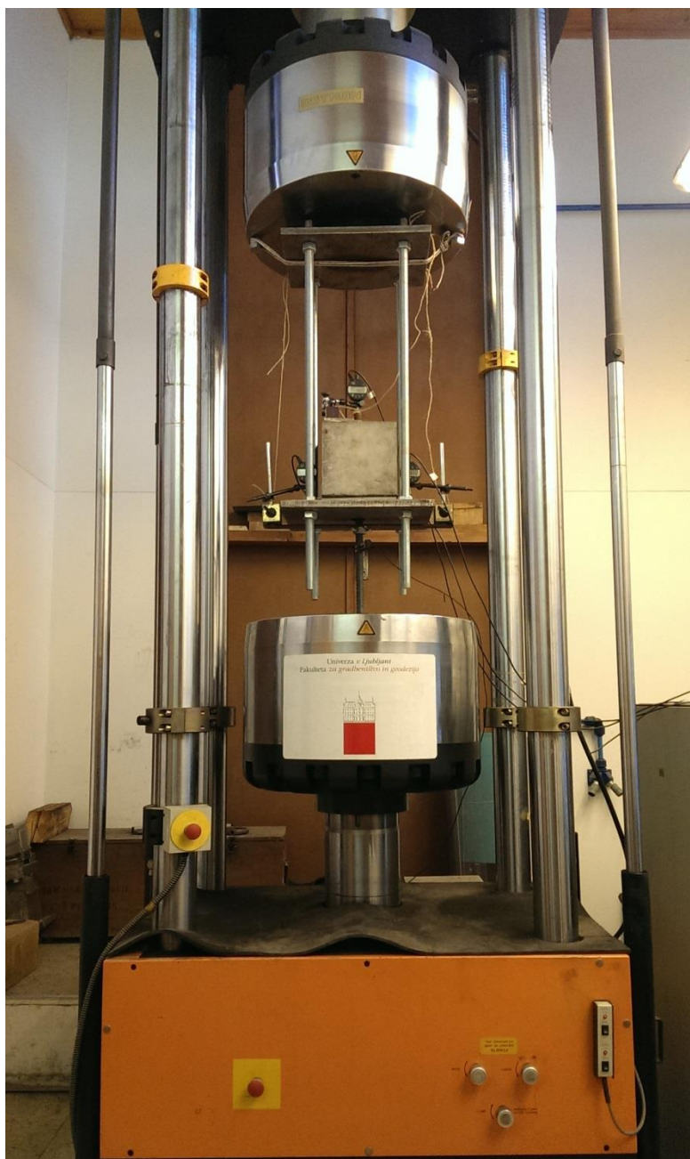
Slika 15: Pripravljen preizkušaneec za izvedbo izvlečnega testa.
