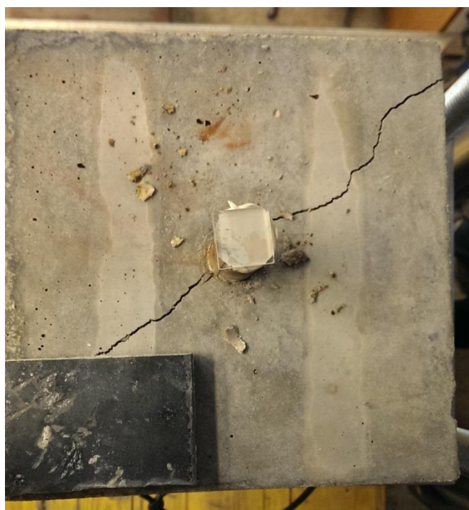
Slika 17: Porušitev preizkušanca NC-1630-1_1 po diagonali.
