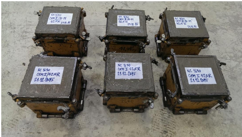
Slika 12: Priprava preizkušancev za preizkus tlačne trdnosti betona.
