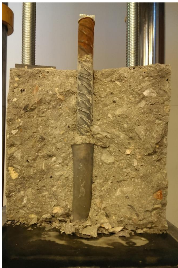
Slika 18: Porušitev preizkušanca NC-1630-3_2.
