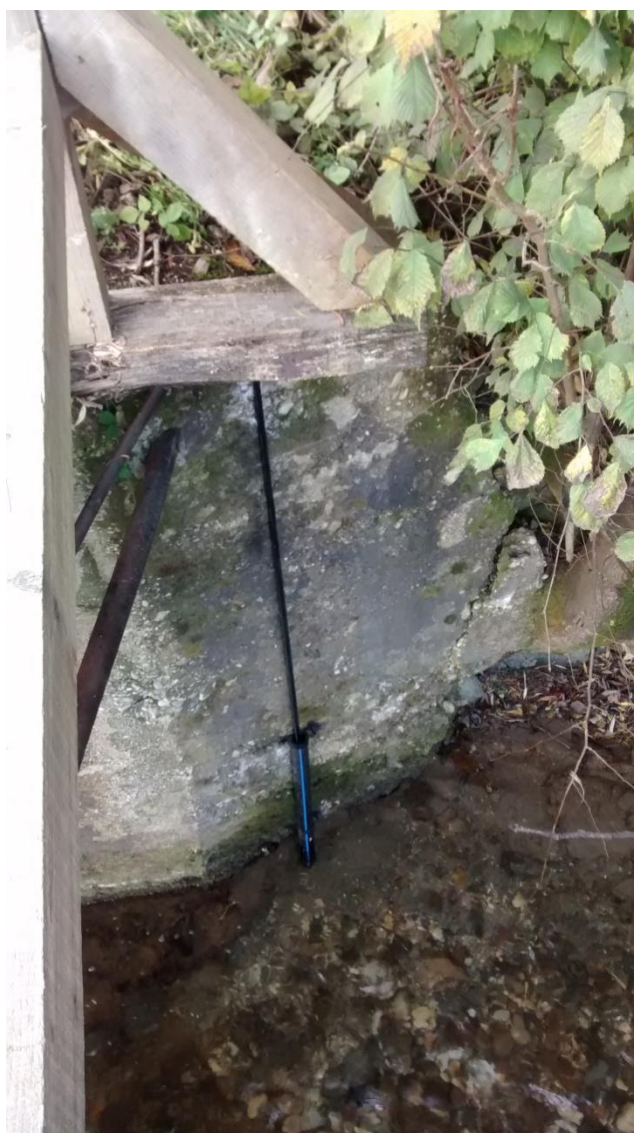
Slika 13: Hydrolab MS5 na merilni postaji Dvor - Gradaščica (osebni arhiv doc. dr. Simona Rusjana, 2016)
