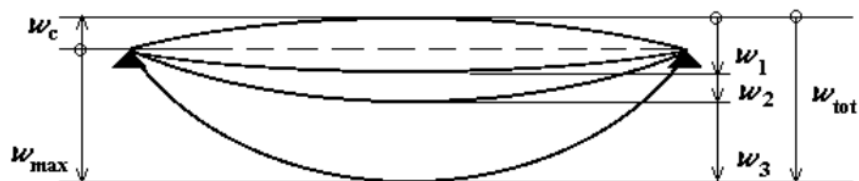
Slika 42: Shematični prikaz navpičnih upogibkov (standard [1]: str. 43)
