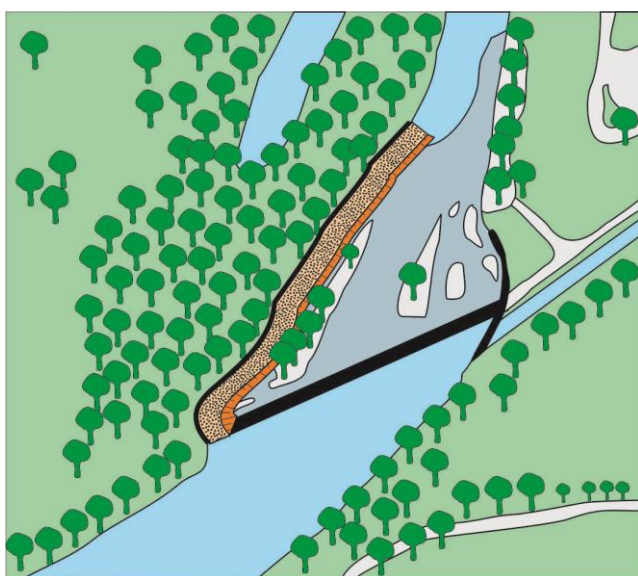
Slika 33: Shematski prikaz urejenosti območja z izgradnjo ribje klančine v strugi Save Bohinjke.
