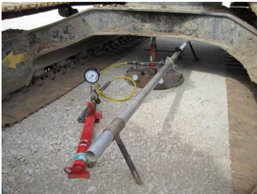
Slika 11: Oprema potrebna za meritve s krožno obremenilno ploščo ( http://www.howland.co.uk/Site-Investigation/Plate.html )
