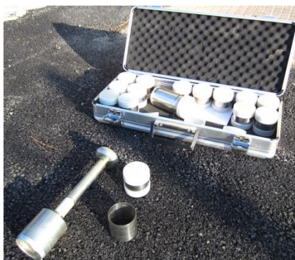
Slika 71: Kopeckijev cilindar za odvzemanje neporušnih vzorcev.
