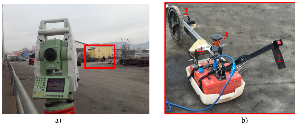
Slika 120: a) Elektronski tahimeter Leica TCRP 1201+ s samodejnim prepoznavanjem reflektorja in sledenjem v testnem območju I; b) Georadarski sistem SIR 3000, 400 MHz monostatična antena: 1) vlečna palica, 2) merilno kolo, 3) reflektor Leica GRZ4 in 4) izdelan nastavek za reflektor.
