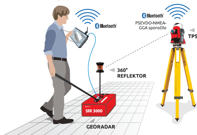
Slika 65: Vzpostavljen sistem terestričnega spremljanja kinematičnega procesa v kombinaciji s TPS in georadarjem, opremljenim s 360° reflektorjem (Boniger in Tronicke, 2010).
