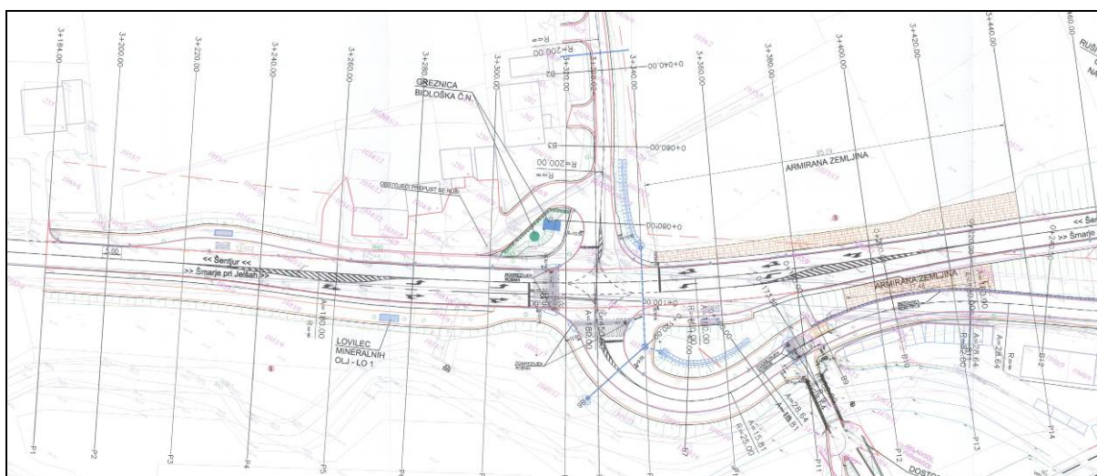
Slika 8.2: Gradbena situacija štirikrakega semaforiziranega križišča [62]
