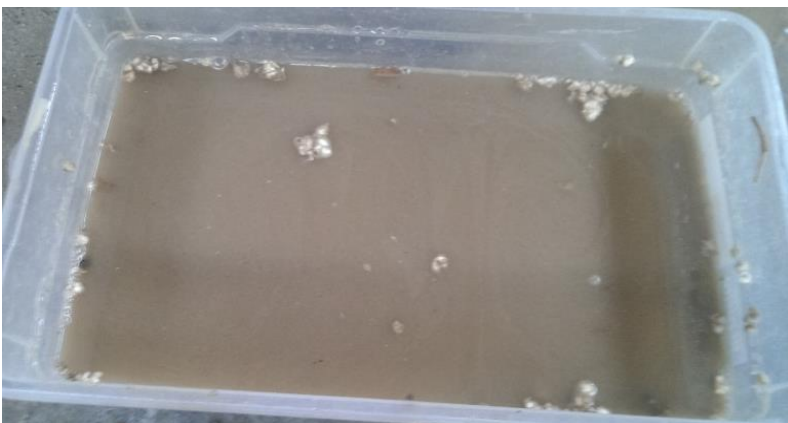
Slika 30: Odstranjevanje nezaželenih primesi (les, polistiren)
