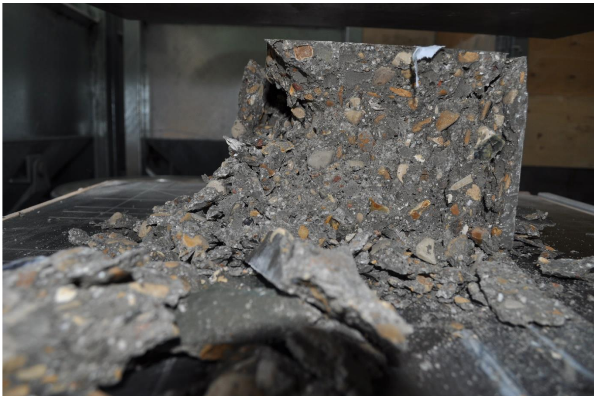
Slika 31: Primer porušitve pri mešanici RCA_30%
