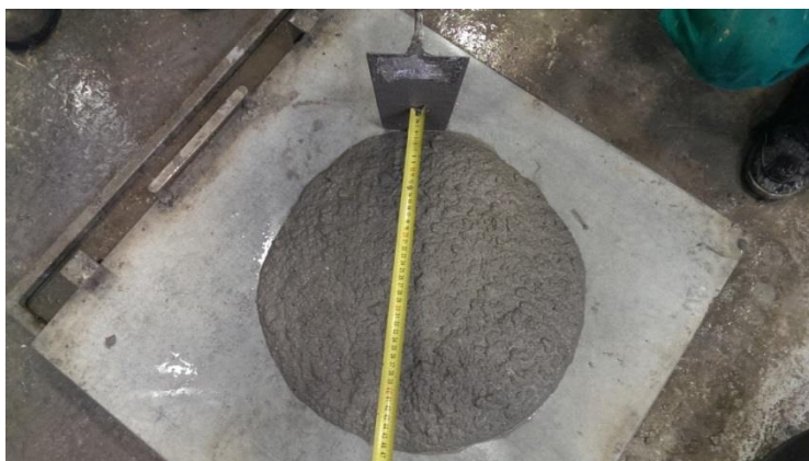
Slika 5.41: Merjenje razleza sveže betonske mešanice
