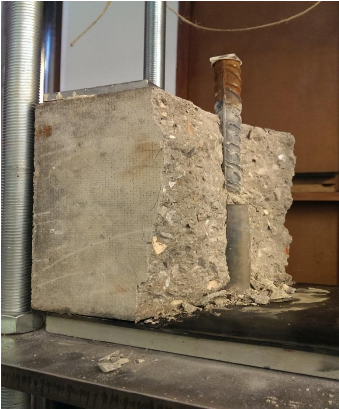
Slika 5.142: Prikaz razcepa betona pri izvleku armaturne palice
