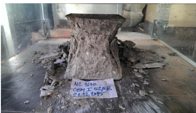
Slika 5.70: Porušitev betona pri enosnem tlačnem preizkusu
