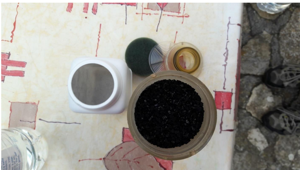
Slika 18: Priprava filtra z aktivnim ogljem na menjavo
