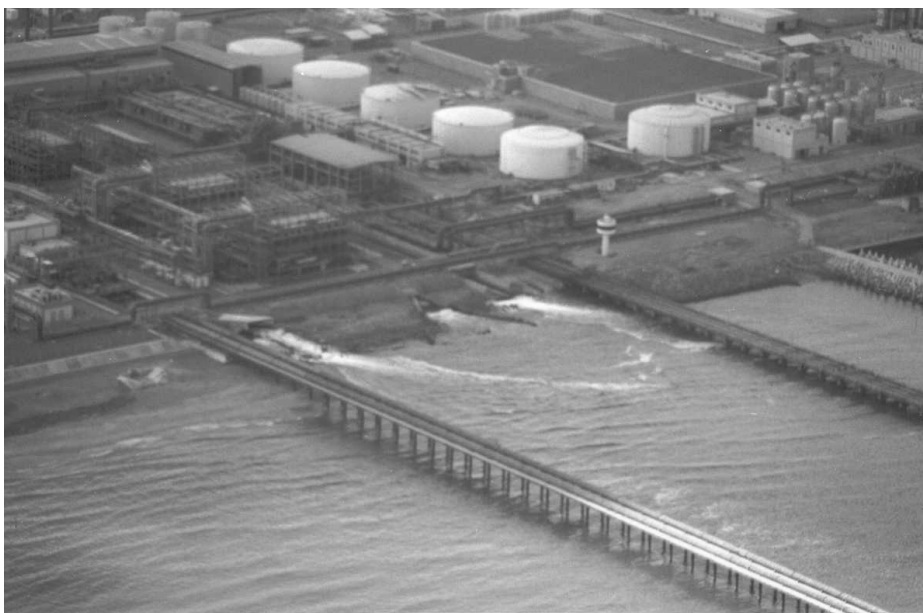
Slika 12: Obrat razsoljevanja Al Ghubrah v Omanu. Na sliki je viden izpust slаницe v morje (BrineDis, 2016).
