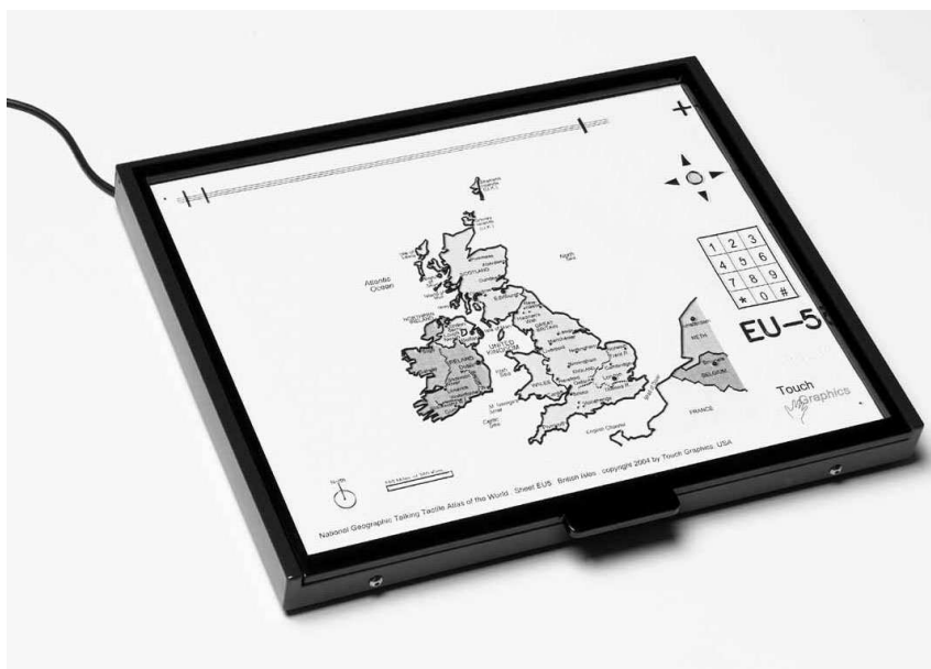
Slika 25: Tipna govoreča plošča dimenzij 38×30.5×2.5 cm oziroma 15×12×1 palca (Miele, et al., 2006, str. 96).
