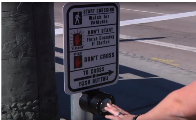
Slika 30: Tipka na drogu semaforja z napotki za varno prečkanje prehoda hibridnega svetilnika. (HAWK Beacon Signal. 2016.)
