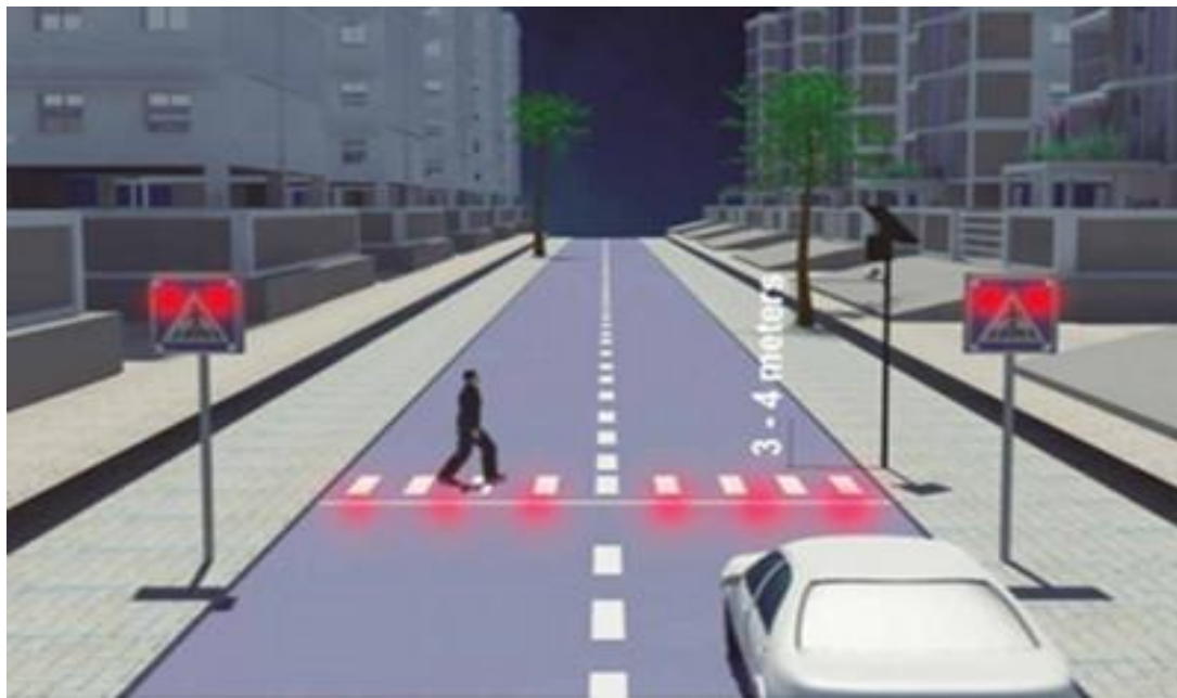
Slika 9: Inteligentni sistem cestnega prehoda SR – IPCS. (LED cestnoprometna signalizacija – Lucia. 2016.)
