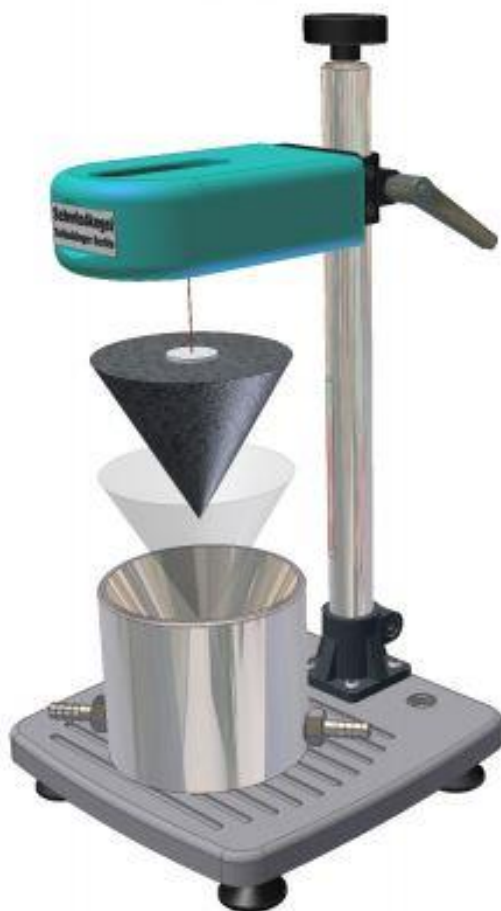
Slika 30: Sestava naprave za merjenje krčenja s stožcem (vir: [31])
