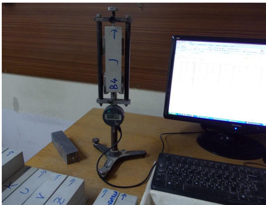
Slika 45: Merjenje dolžin vzorcev
