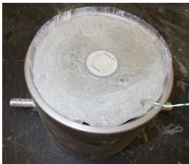
Slika 38: Merjenje temperature v notranjosti vzorca pri metodi krčenja v stožcu
