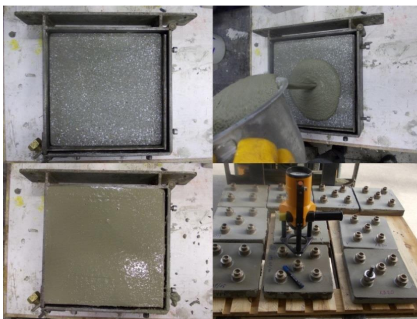
Slika 10: Prikaz nanosa sloja malte na betonsko podlago in merjenje sprijemnih trdnosti
