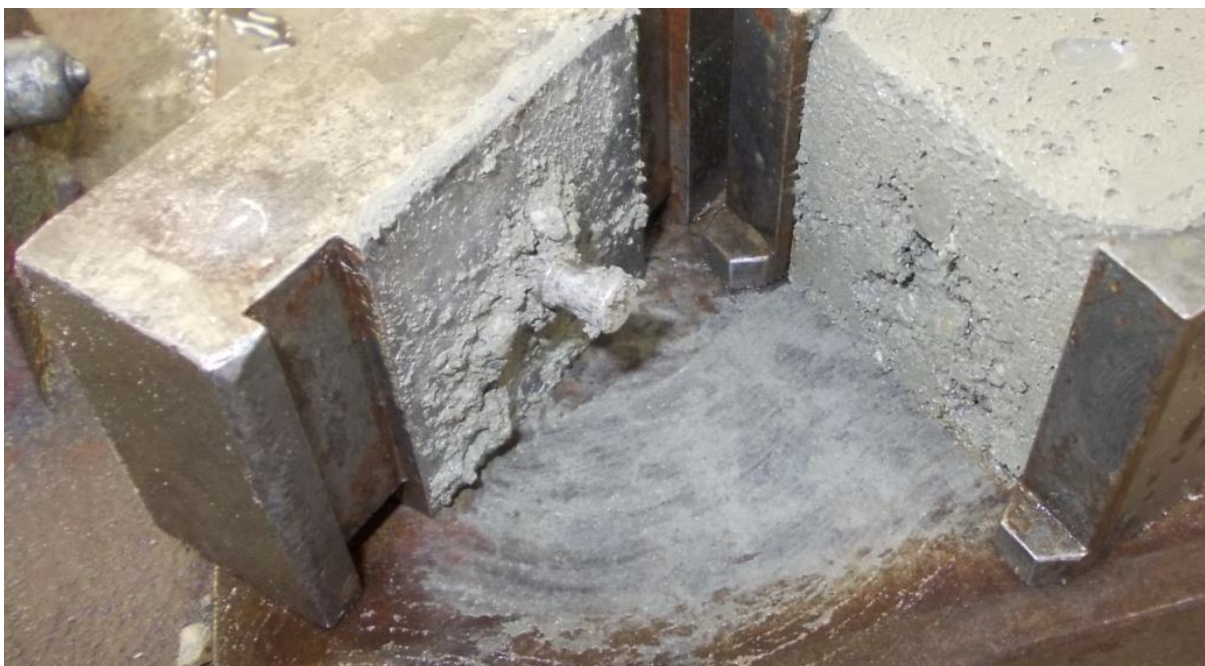
Slika 55: Neuspelo razkalupljenje ob času konca vezanja
