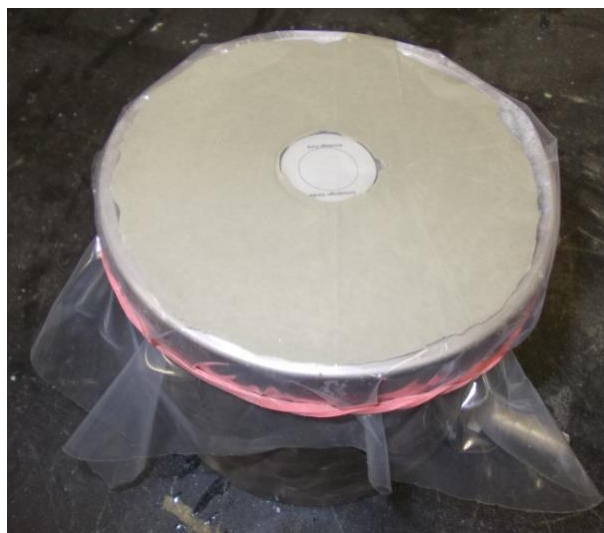
Slika 34: S plastično folijo prekrita površina vzorca za merjenje avtogenega krčenja
