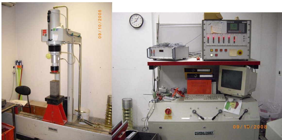
Sliki 10 in 11: Naprava za preskušanje – stiskalnica in njen krmilni del
