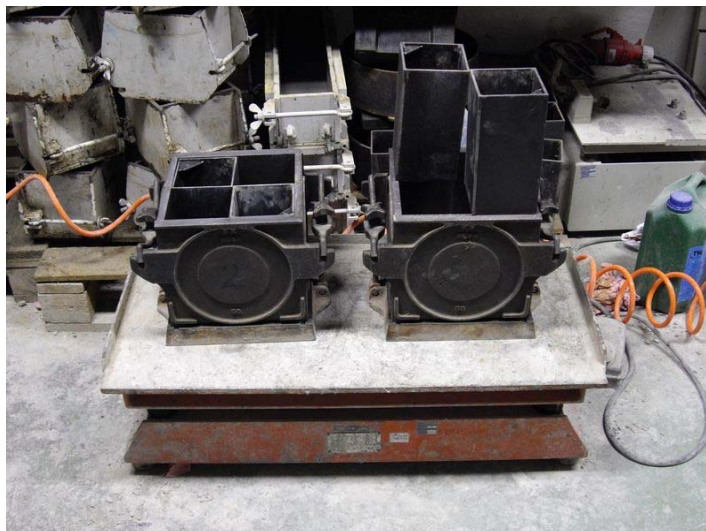
Slika 8: Uporabljeni kalupa z "vložki" na stresalni mizici
