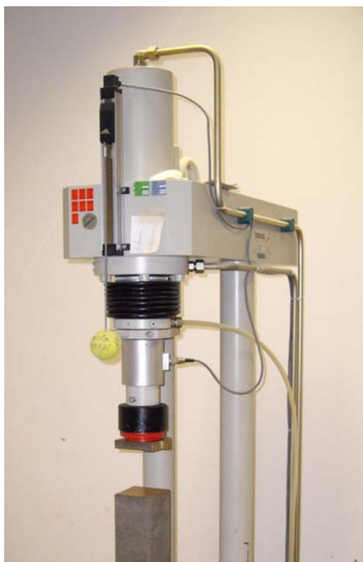
Slika 9: Bat stiskalnice s kalibriranim merilcem pomikov
