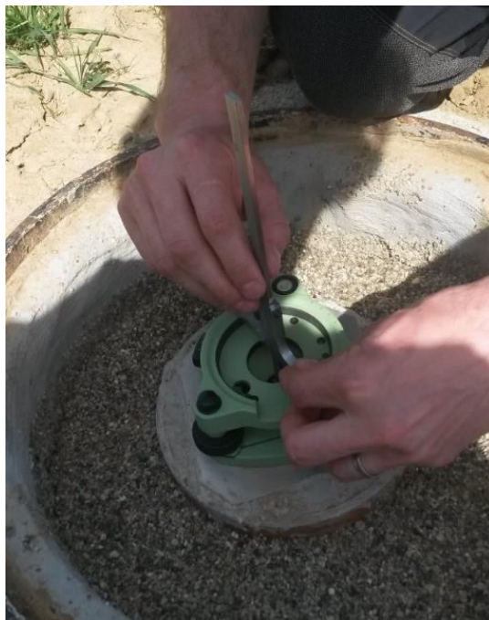
Slika 11: Merjenje višine prizme nad navojem s kljunastim merilom
