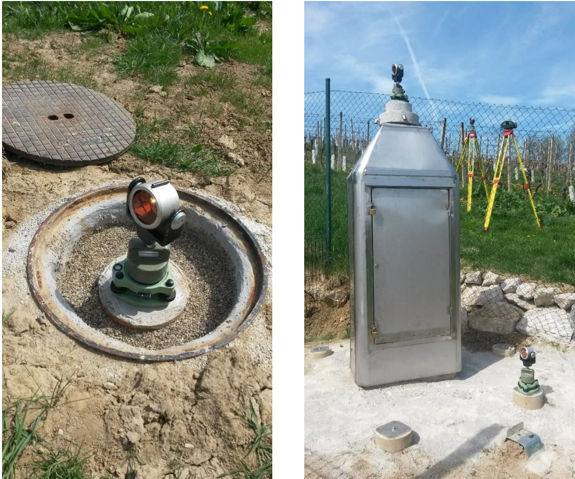
Slika 10: Prizma GPH1P na točki KOG2 (leva slika), signalizacija na referenčni točki KOG0, talnem reperju KOG4 in na vezni točki S1 v ozadju (desna slika)
