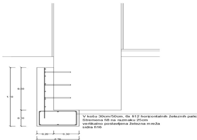
Slika 26: Detajl utrditve temeljnega zidu cerkve
