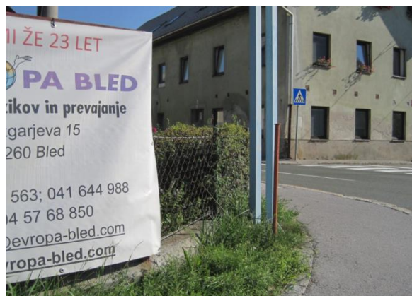
Slika 64: Preglednost 1 m od vozišča v višini otroka ob desnem robu prehoda za pešce
