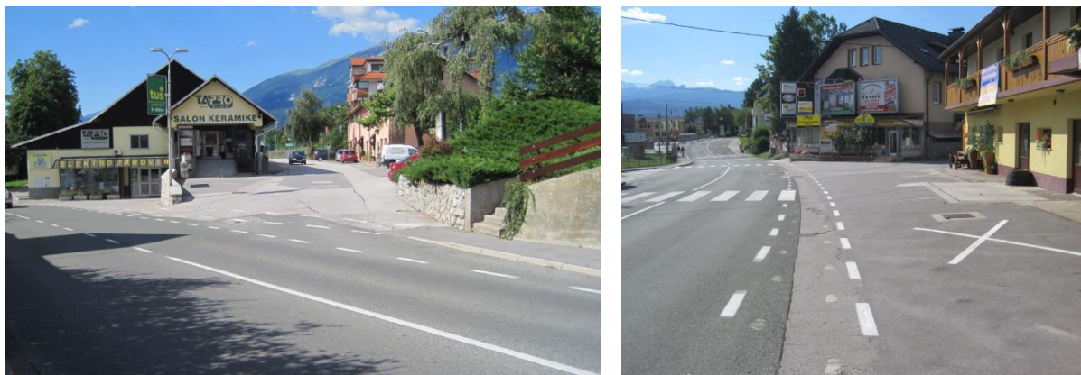
Slika 70: Pločnik prehaja v pas za pešce (levo) in prečka široko dostopno površino in nadaljuje pot mimo trgovin in podjetij z lastnimi parkirišči (desno)
