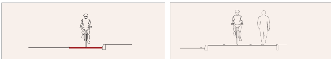
Slika 32: Kolesarski pas (levo) in kolesarska steza (desno) (Navodila za projektiranje kolesarskih površin, 2012: str. 12, 13)
