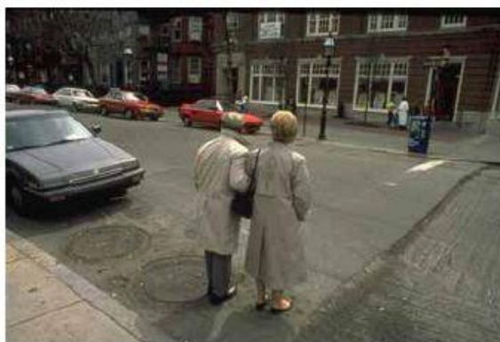
Slika 31: Problematično nezavarovano mesto prečkanja zaradi parkiranih avtomobilov pred križiščem (Pedestrian Design at Intersections, 2006: str. 2)
