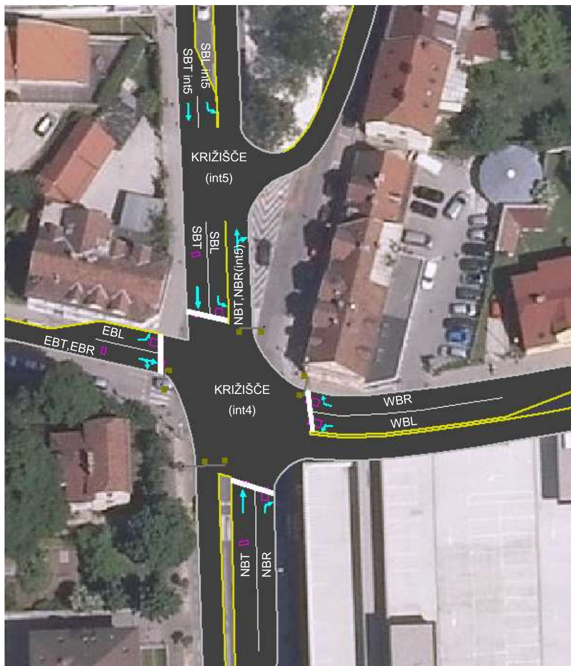
Slika 33: Prikaz predvidenega semaforiziranega križišča
