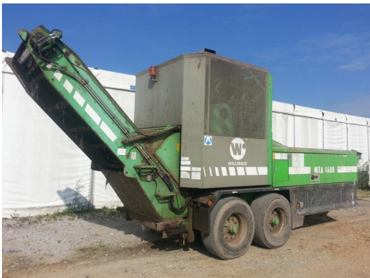
Slika 23: Mobilni drobilnik VILLIBALD MZA 4600 (kompostarna CRO Vrhnika)
