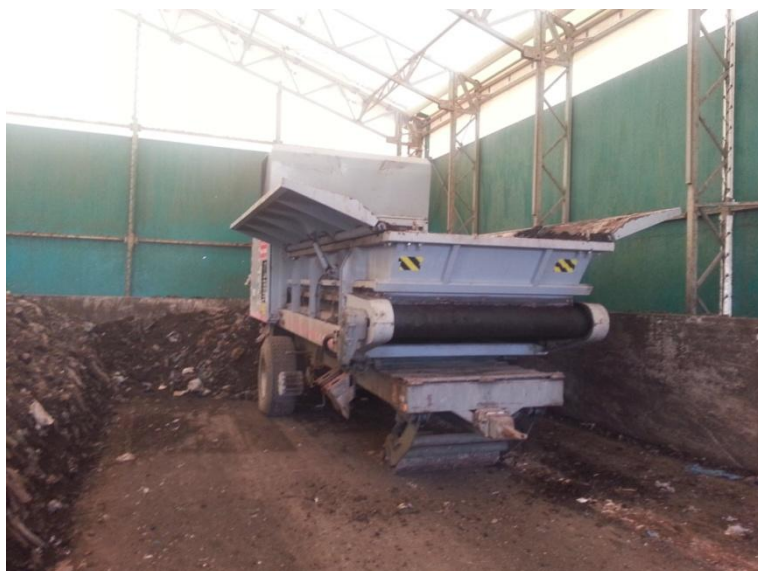
Slika 32: Mešanje kompostnega materiala z mobilnim mešalnikom komposta »JENZ MU 2000 D« (kompostarna CRO Vrhnika)
