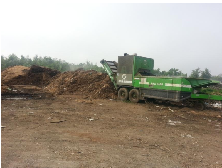
Slika 23: Mobilni drobilnik VILLIBALD MZA 4600 (kompostarna CRO Vrhnika)
