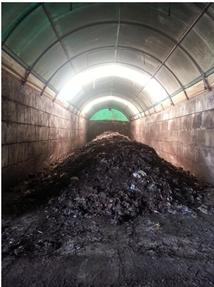
Slika 27: Kompostna piramida v tunelu – intenzivno zorenje (kompostarna CRO Vrhnika)
