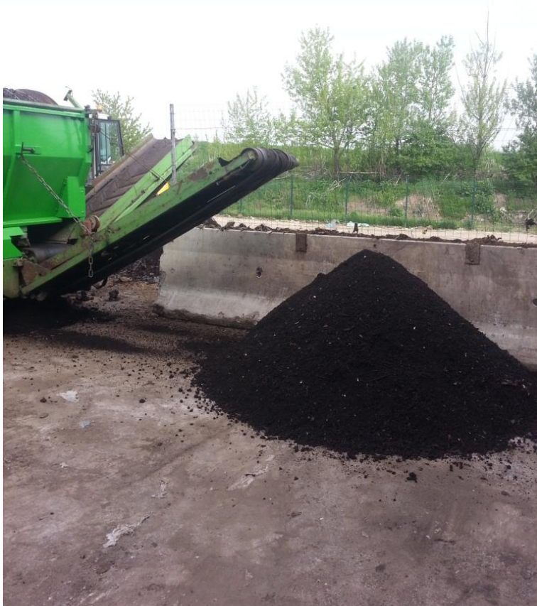
Slika 35: Prečiščen kompost po sejanju z bobnastim sitom FARWICK PRIMUS (kompostarna CRO Vrhnika)
