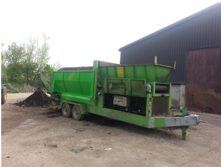
Slika 34: Sejanje komposta z bobnastim sitom RARWICK PRIMUS (kompostarna CRO Vrhnika)
