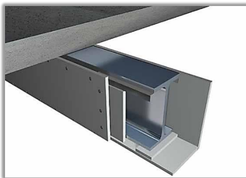
Slika 12 Zaščita jeklenega nosilca z mavčno-kartonskimi ploščami
