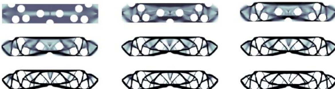
Slika 53: Postopek iteracijskega optimiziranja nosilca [25]
