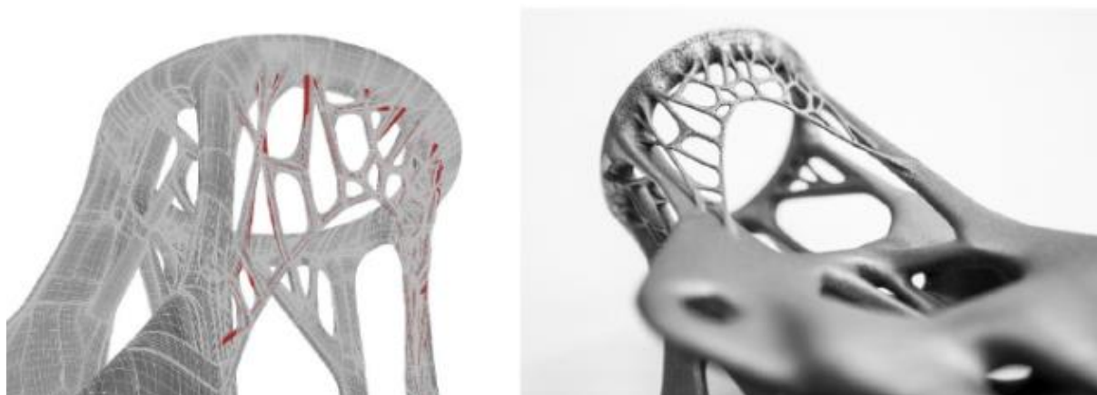
Slika 59: Z rdečo barvo označene podpore (levo) so vključene v končni izdelek (desno) [25].
