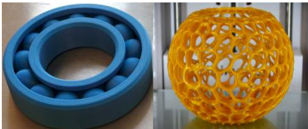
Slika 4: Eksponat z dvojno steno organske oblike (desno) in delujoč ležaj (levo) [1]
