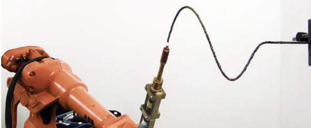
Slika 50: Tiskalnik za tisk v vseh smereh ne potrebuje dodatnih podpor [21]
