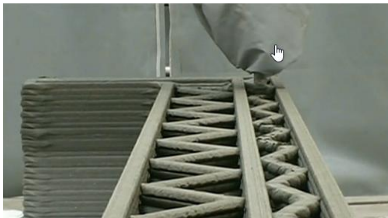
Slika 42: Prikaz značilne diagonalne zapolnitve sten [45]
