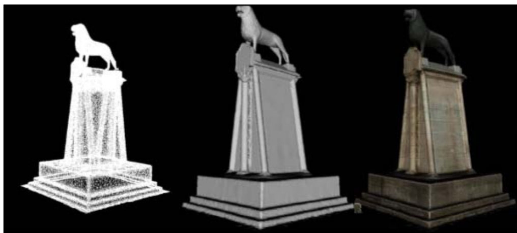
Slika 26: Žični model (levo), senčenje površine (sredina) in foto – realistični model (desno) [14]
