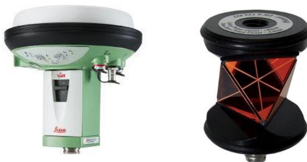
Slika 4: GNSS-antena (levo) in 360° prizma (desno) (vir: Leica Geosystems, ScsSurvey, 2016)
