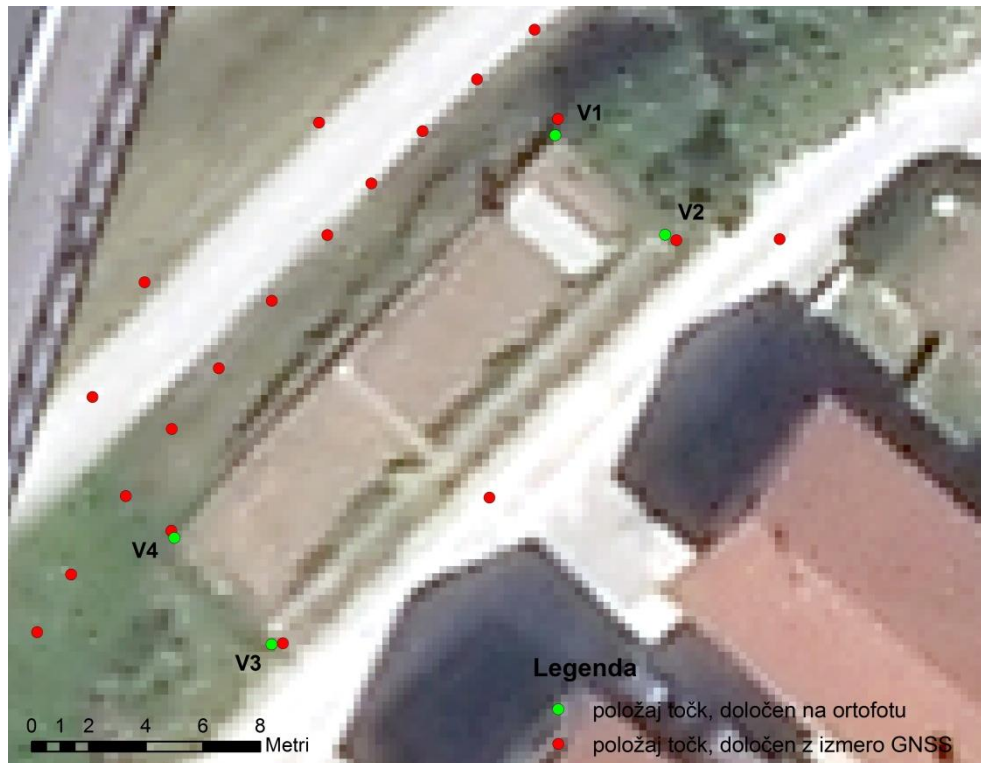
Slika 12: Poloflaj točk vrta, določen na ortofotu, je prikazan z zelenimi krogi, poloflaj točk, določen z izmero GNSS, je prikazan z rdečimi krogi
