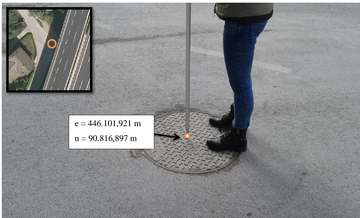
Slika 9: Izmera za dolo itev koordinat kanalizacijskega ja–ka
