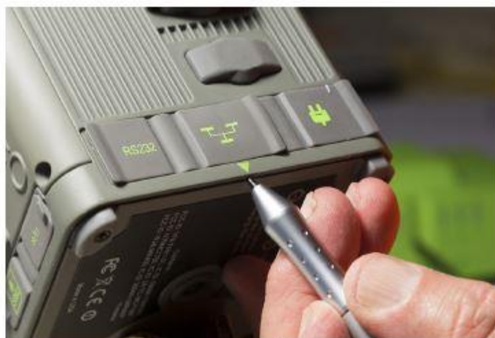
Slika 6: Merjenje višine antene pri Javadu (vertikalno ali poševno) – NGS, 2016
