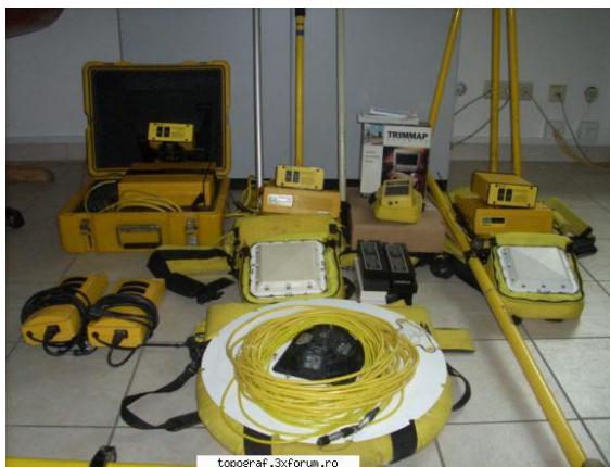
Slika 3: Instrument Trimble 4000 SSi (za RTK-metodo izmere)
