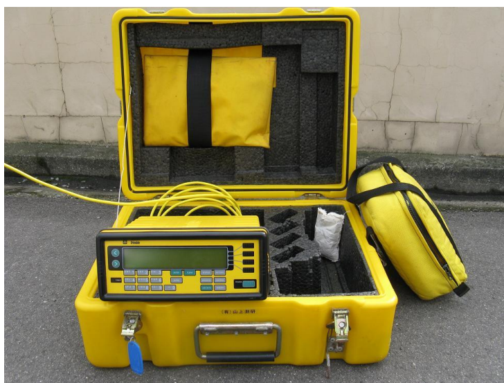
Slika 2: Instrument Trimble 4000 SSi (za statično izmero)
