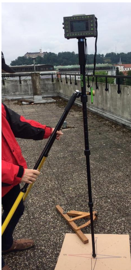
Slika 14: Instrument JAVAD TRIUMPH-LS z dvonožnim stojalom in vetrovnico, ki nam je služila za hitro orientacijo
