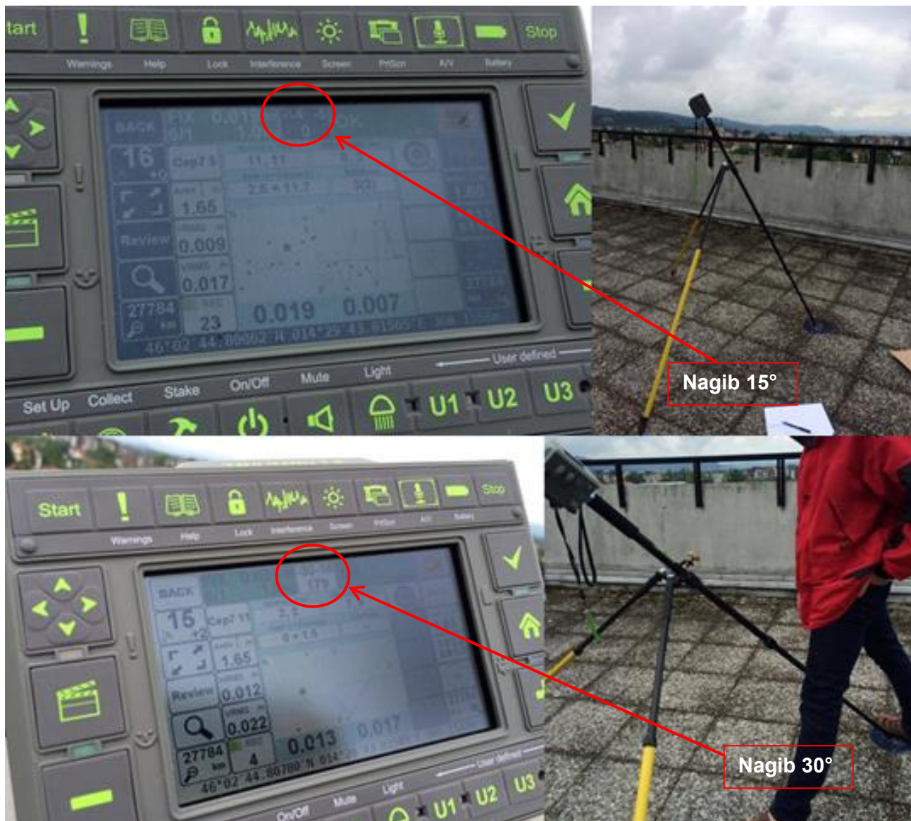
Slika 15: Prikaz postavitve instrumenta na točko CEP7 pri nagibu 15^\circ in 30^\circ
