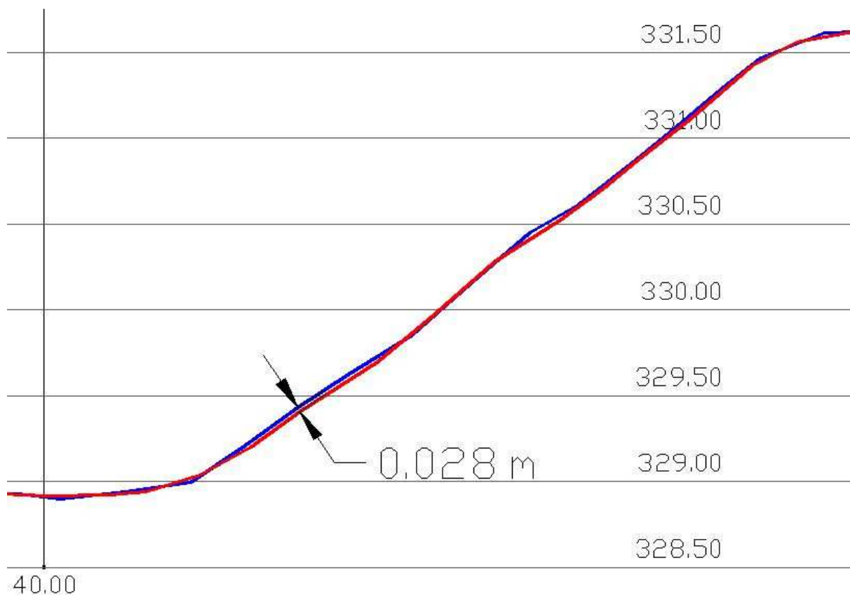
Slika 15: Izsek iz prečnih profilov dveh ploskev
