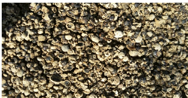
Slika 22: Izločene s kalcijevim karbonatom obložene granule iz dna R2S reaktorja ČN Skidel (lasten vir)
