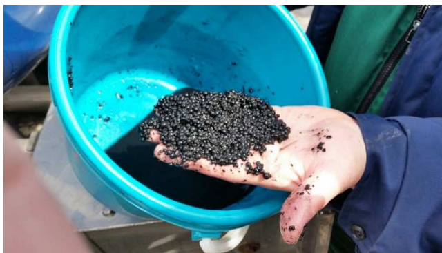
Slika 23: Aktivne granule biološkega blata R2S reaktorja ČN Skidel (lasten vir)
