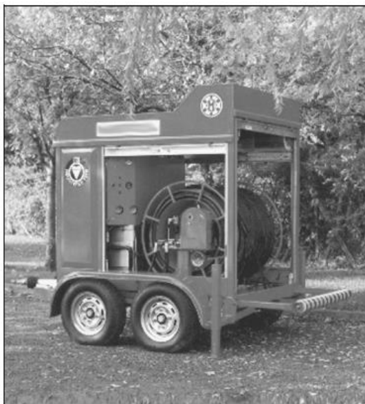
Slika 37: Stroj za pršenje epoksi smole (AWWA, 2001)
