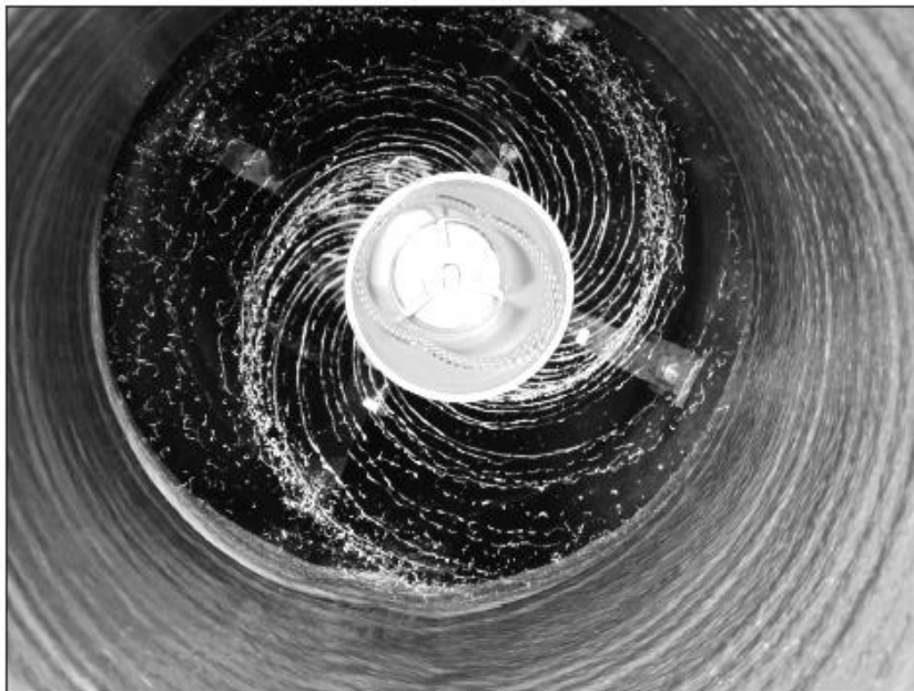
Slika 36: Pršilna glava med delom (Sunidh, 2015)
