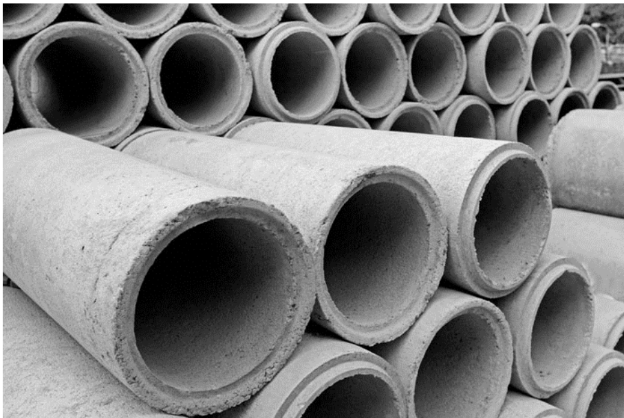
Slika 6: Azbestno cementne cevi (Bracken in Johnston, 2013)
