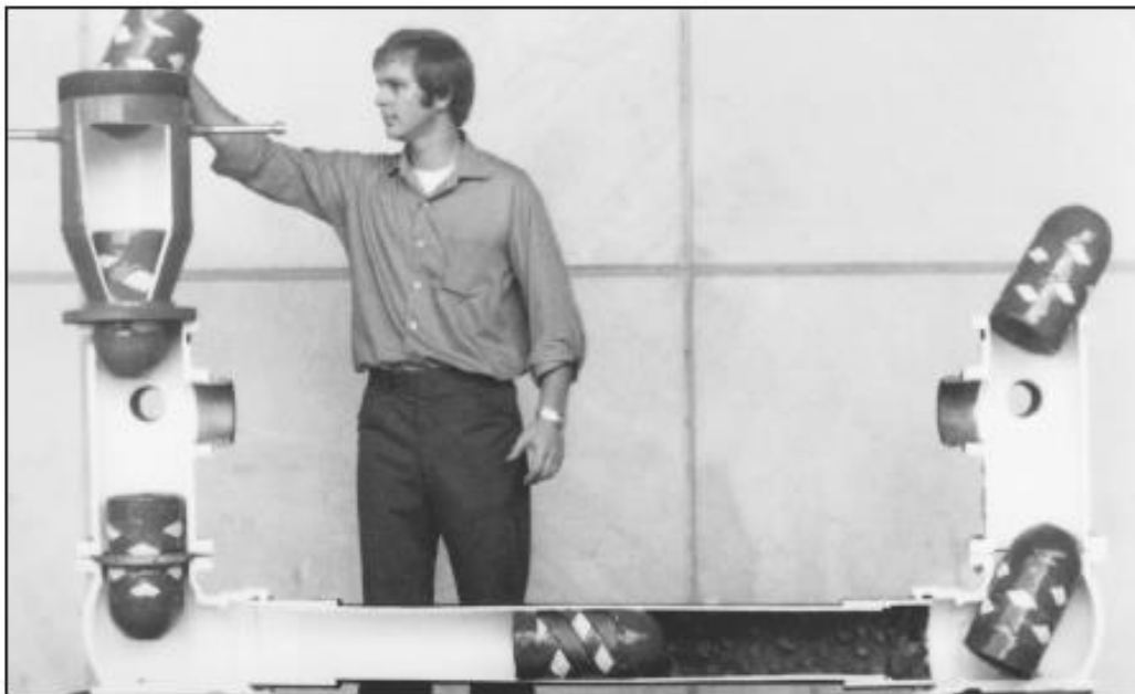
Slika 26: Prikaz vstavljanja nabojev v hidrant (AWWA, 2001)
