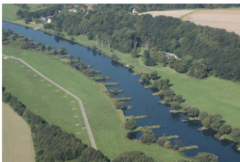
Slika 36: Zaporedno postavljeni odbijači toka v reki Ruhr (Ruhr, 2015)
