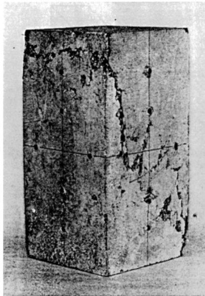
Slika 16: Vzorec po kompresijskem stiskanju kaže vpliv poravnave vlaken na potek razpok
