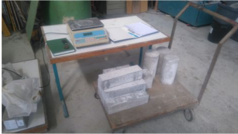
Slika 35: Vzorce je bilo potrebno pred preizkusom kontrolno stehtati in premeriti
