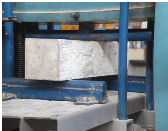
Slika 39: Preizkus upogibne trdnosti 2
