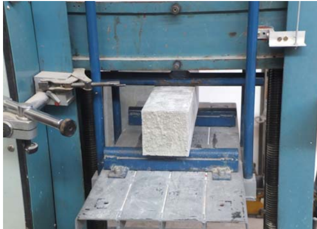
Slika 38: Preizkus upogibne trdnosti 1
