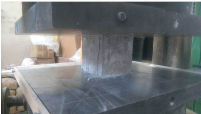
Slika 33: Kocka v stiskalnici; vidne so vertikalne razpoke
