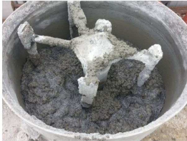
Slika 28: Jeklana vlakna JV 40/16 v planetarnem mešalcu za 3. serijo
