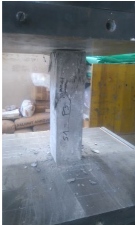
Slika 37: Razpokana prizma pri tlačnem preizkusu; vidi se potek posameznih razpok
