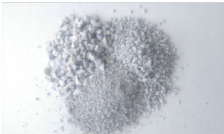
Slika 19: Kamnolomski drobljeni agregat iz treh frakcij za betonsko mešanico 0/16 mm
