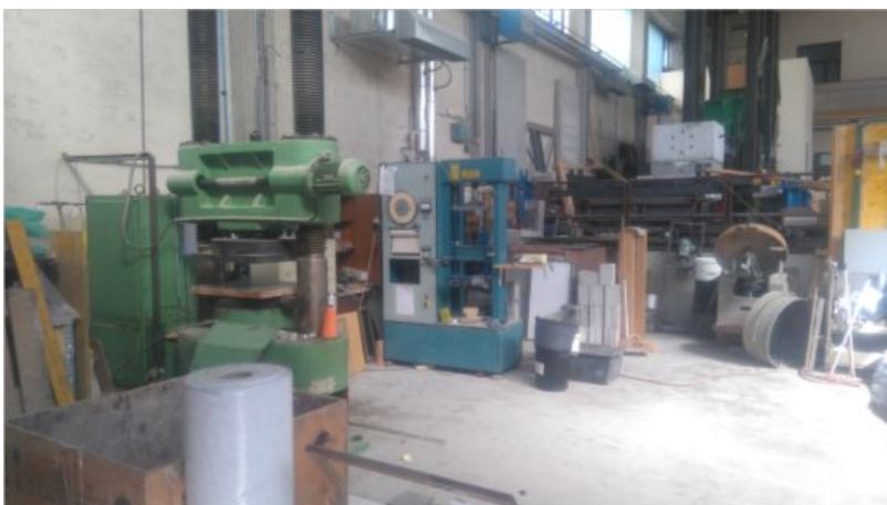
Slika 34: Hidravlična stiskalnica za preizkus tlačne trdnosti (zelena) ter stroj za preizkus upogibne trdnosti (obarvan modro)
