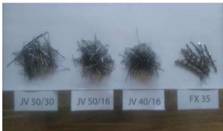
Slika 23: Jeklena vlakna, uporabljena v betonih za preizkuse, ki smo jih obravnavali v okviru diplomske naloge
