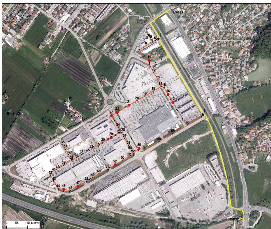
Slika 14: Odstopanja višin dnov jaškov za več kot 5 cm od projektirane višine.
