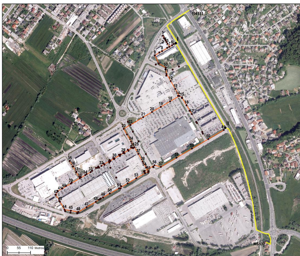
Slika 9: Potek nivelmanske izmere (rumena linija) in prikaz navezovalnih točk višinskega poligona trigonometričnega višinomerstva (rjava linija).
