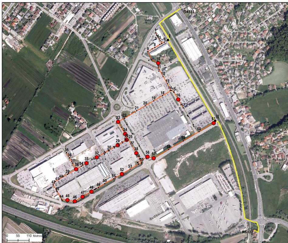
Slika 13: Prikaz odstopanj dnov jaškov za več kot 5 cm.
