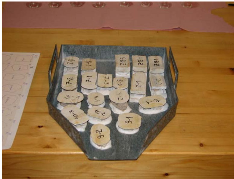
Slika 34: Vzorci malte, pripravljene za tlačni preizkus
