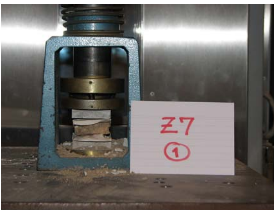
Slika 35. Tlačni preizkus malte, začetek, vzorec Z7-1
