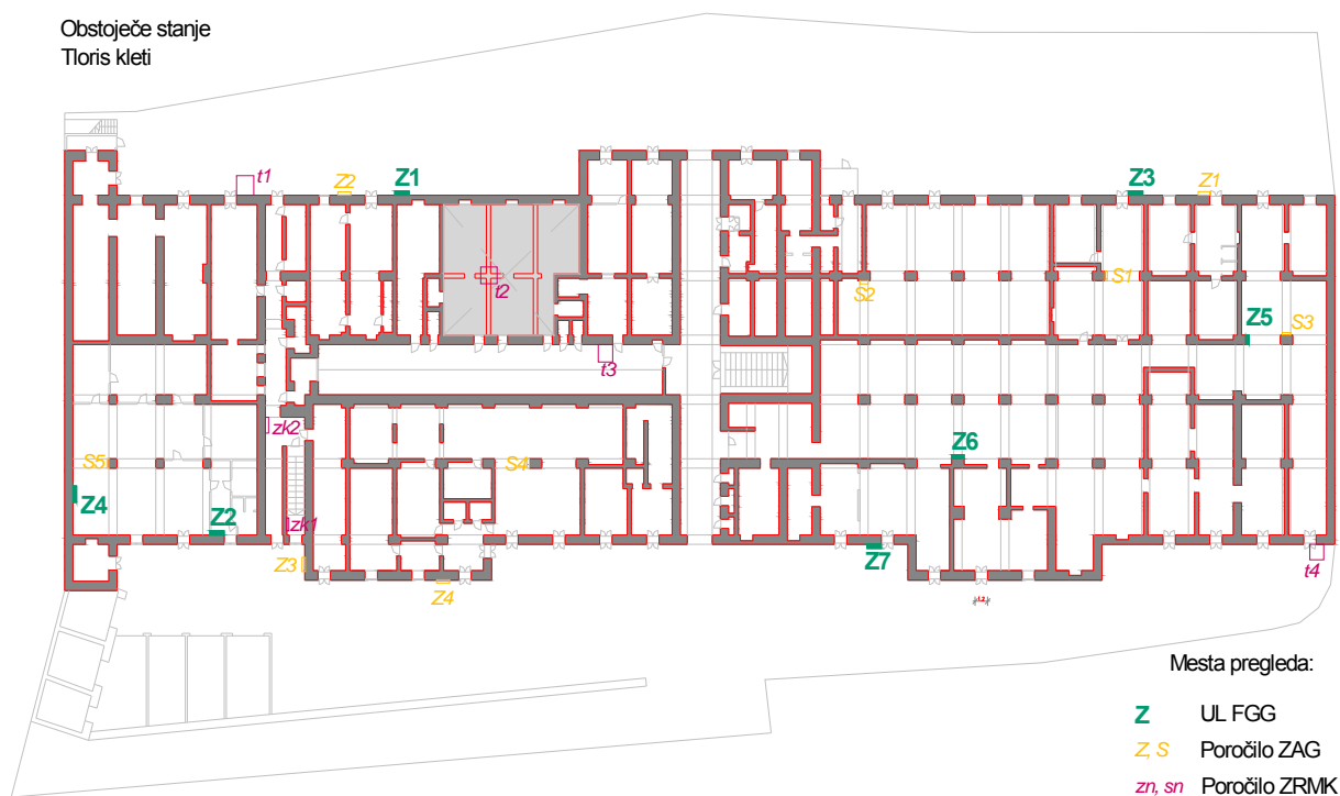
Slika 20: Mesta odvzema, kletna etaža (Z – zid, S – strop, t – temelj)
