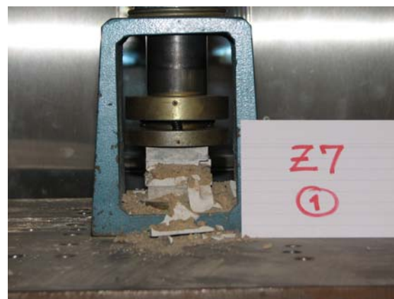
Slika 36. Tlačni preizkus malte, porušitev vzorca Z7-1
