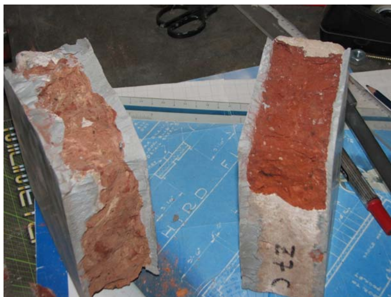
Slika 33: Porušena vzorca, kjer je vidna različna struktura; levo nehomogena struktura vzorca Z7b, desno homogena struktura vzorca Z7c
