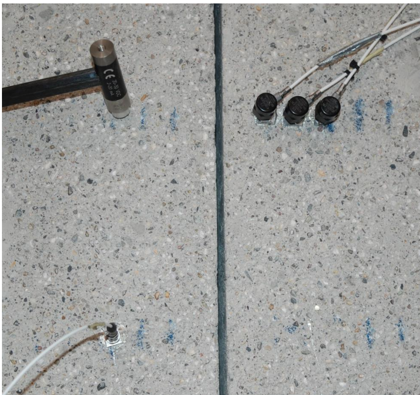
Slika 32: Primer postavitve merilnih naprav.
