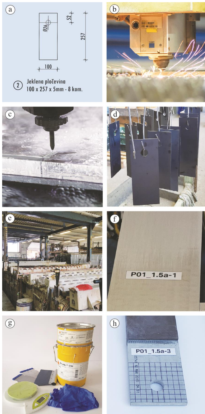
Slika 6.18: Pripravljalna dela: a-vektorski izris v AutoCAD-u, b-laserski rezalni stroj, c-rezalnik z vodnim curkom, d-oksidirana pločevina, e-kadi za jedkanje, f-grobo obrušen laminat, g-lepilo Sikadur 330, h-izris mreže na preizkušancu.
