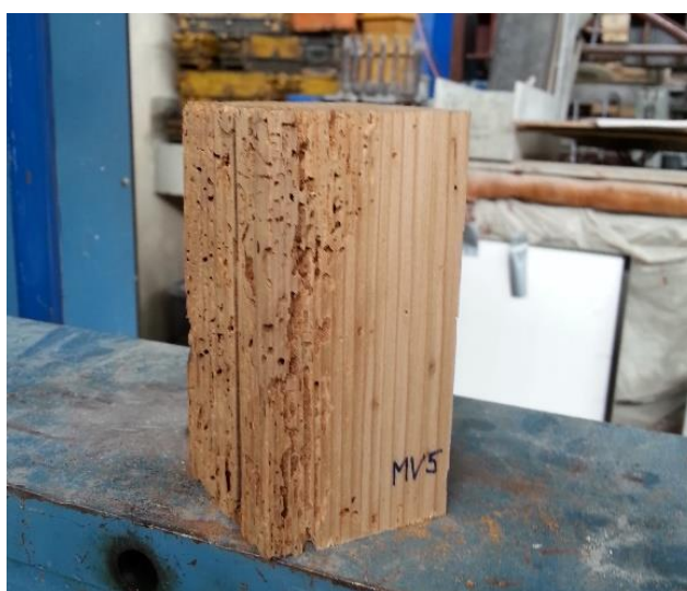
Slika 15: Preizkušavec pridobljen iz smrekovega lesa kapne lege iz ostrešja z vidno luknjičavostjo.
