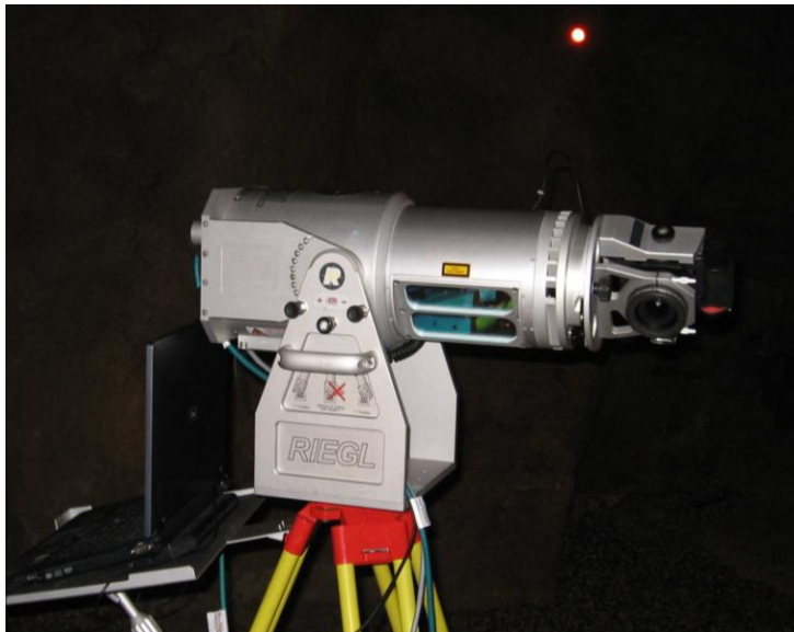
Slika 59: Riegl LMS-Z420i pri praktičnem delu (Bradán, T., Per, J., Peterka, P., Vodišek, D., 2007: 6 str.)
