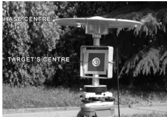
Slika 9: Tarča, namenjena za direktno georeferenciranje skenerja, opremljena s satelitskim sprejemnikom (Balzani, M. et al. 2006: 29 str.)
