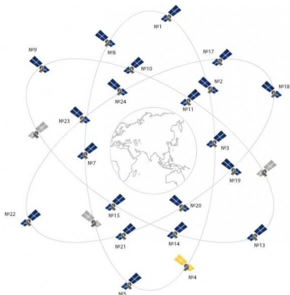
Slika 3: konstelacija GLONASS-ovih satelitov (GLONASS, 2016b).
