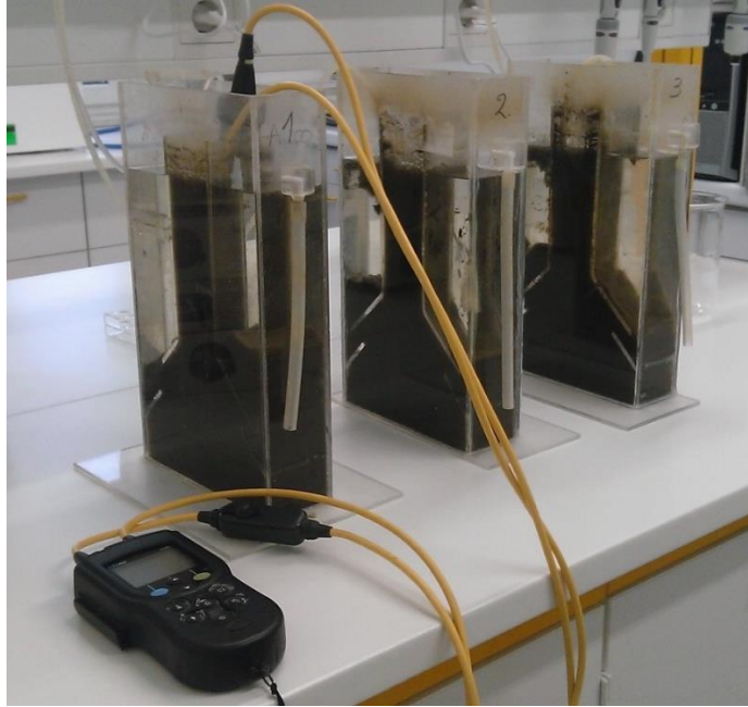
Slika 24: Merjenje fizikalno-kemijskih parametrov s prenosnim dvokanalnim multimetrom Hach Lange HQ40D
