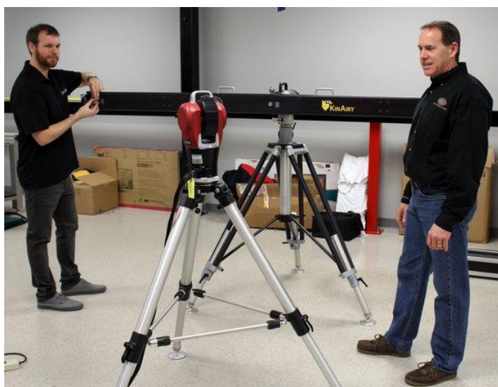
Slika 34: Preizkus laserskega sledilnika z merjenjem dolžinskega etalona ( www.twitter.com/brunsonus )
