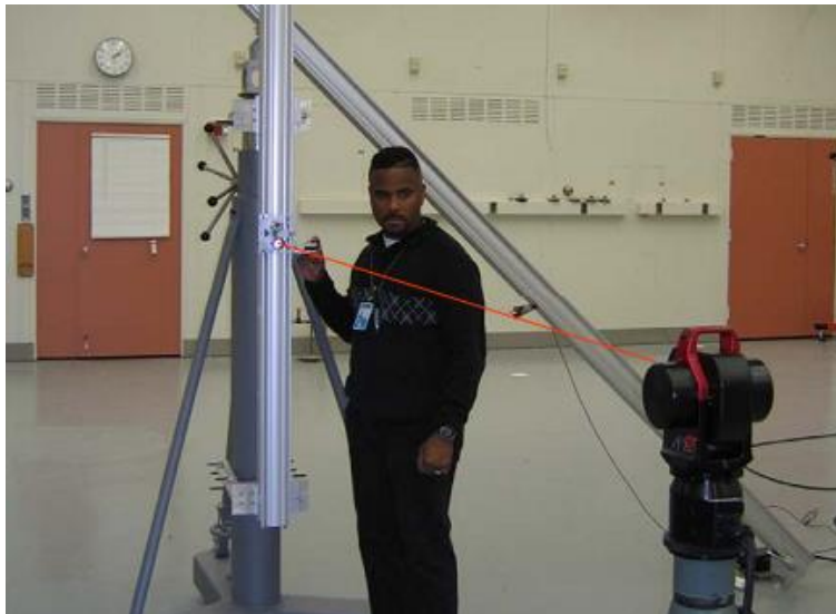
Slika 31: Preizkus določitve položaja v dveh krožnih legah (Phillips S. D., 2009)
