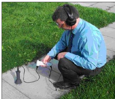
Slika 29: Iskanje mesta okvare nad osjo cevi, z uporabo metode s talnim mikrofonom [25, str.21]
