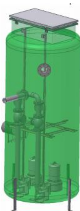
Slika 33: Tipsko črpališče za odpadne vode (vir: Regeneracija)
