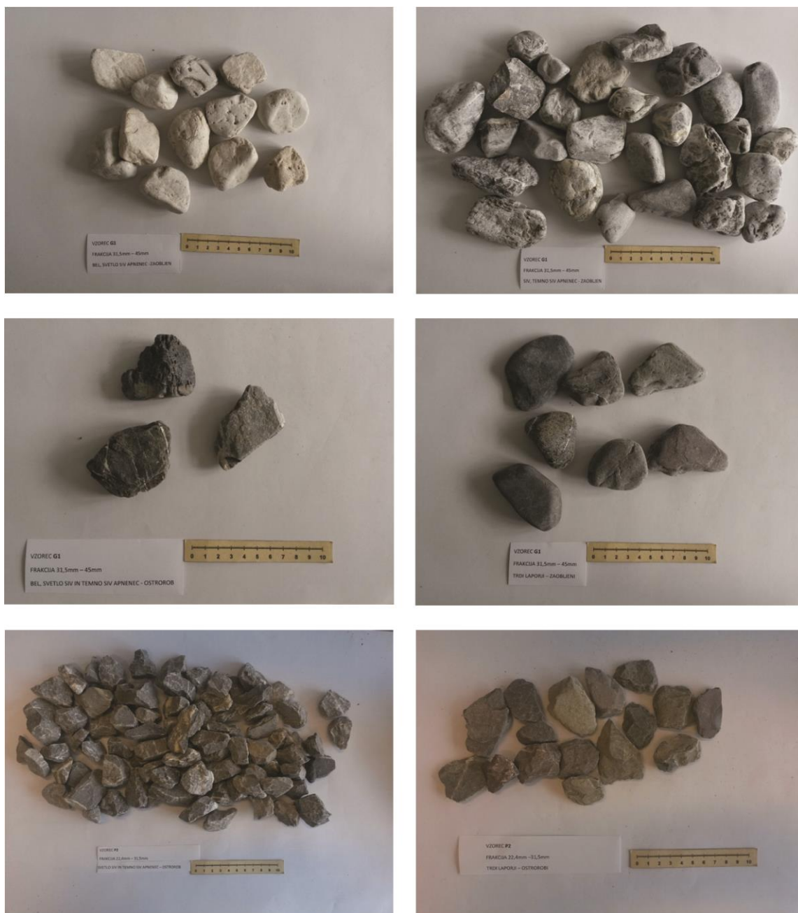
Slika 19: Različna zrna glede na velikost, obrušenost in petrografsko sestavo
