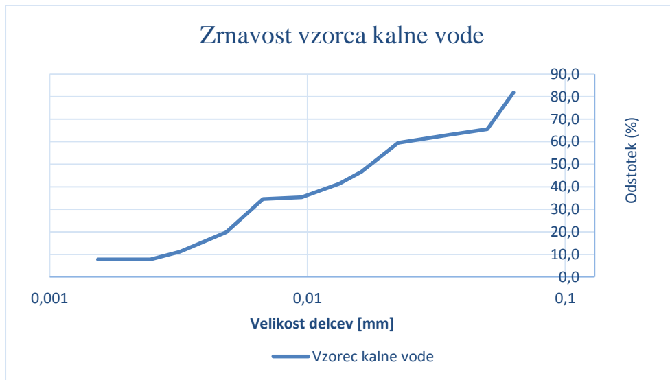
Grafikon 20: Deleži finih delcev v vzorcu kalne vode
