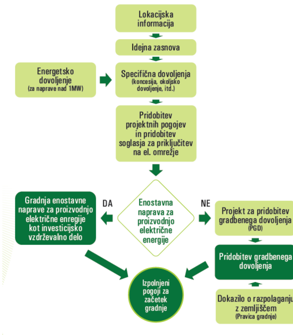
Slika 16: Shema pridobitve potrebnih dovoljenj in soglasij za izgradnjo proizvodnih naprav (vir: ApE, Borzen, SODO, 2012)
