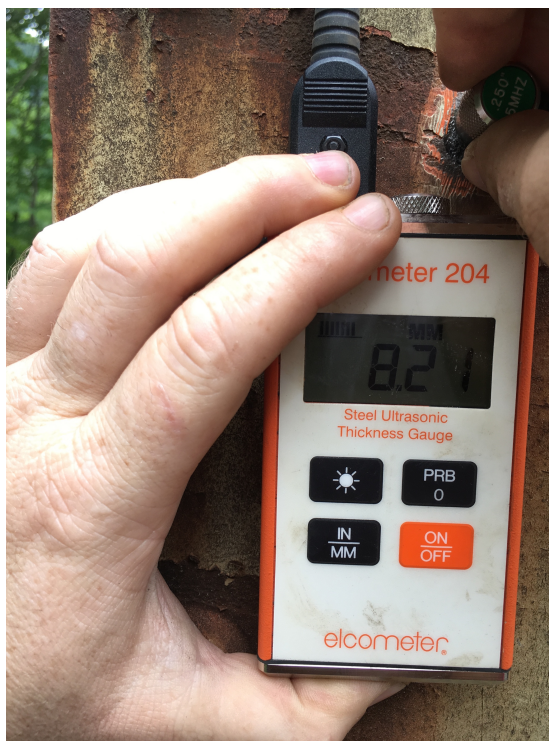
Slika 51: Merjenje izgube debeline profila na ravni zračni površini z elcometrom.
