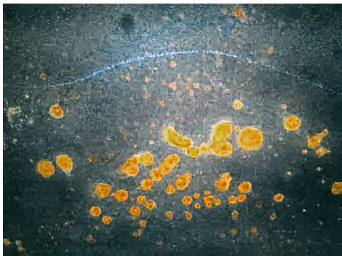
Slika 30: Anaerobna mikrobiološka korozija (Skale, 2016).
