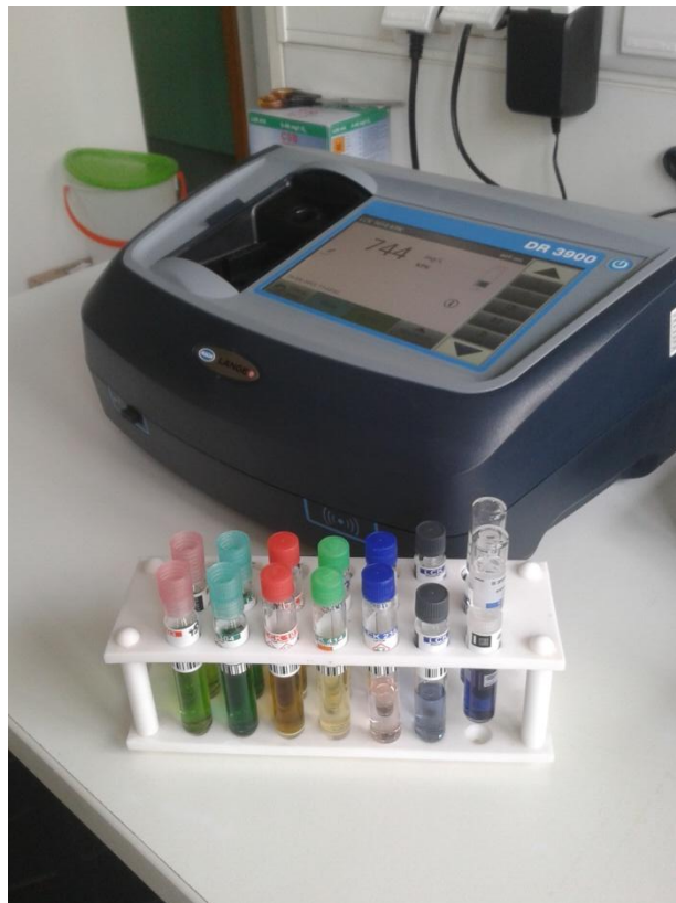
Slika 8: Spektrofotometer in kivete za merjenje parametrov, kot so KPK, amonijev dušik, fosfor
