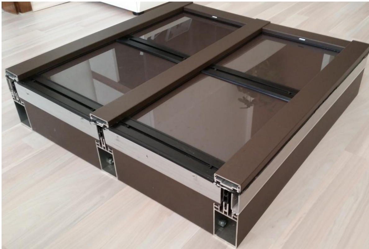
Slika 51: Obravnavani preizkušaneč stekleno-aluminijastega fasadnega sistema
