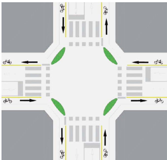
Slika 48: Križišče s kolesarsko stezo na rezerviranem pasu in varovalnimi prometnimi otoki. (Maggio R., Mordà N., 2016: str. 38)
