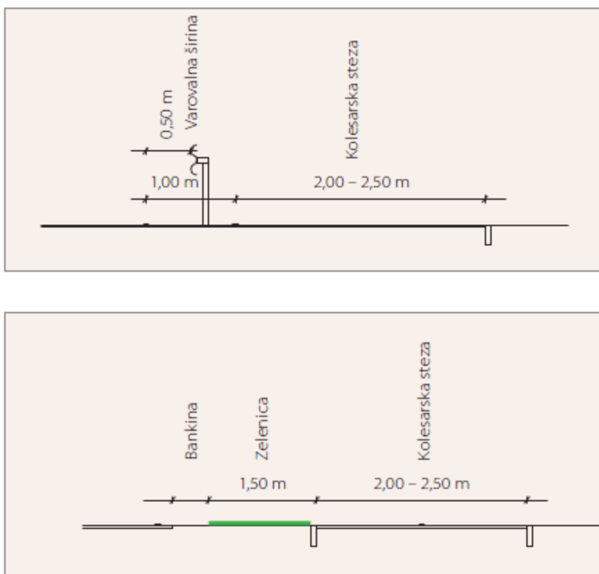
Slika 3: Tipični prerezi kolesarske steze izven naselja (Lipar, P. 2012: str. 21)
