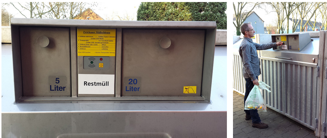
Slika 10: Identifikacijska ključavnica na zabojniku večstanovanjskih objektov [spl. str. št. 3] Figure 10: Refuse container locks [spl. str. št. 3]
