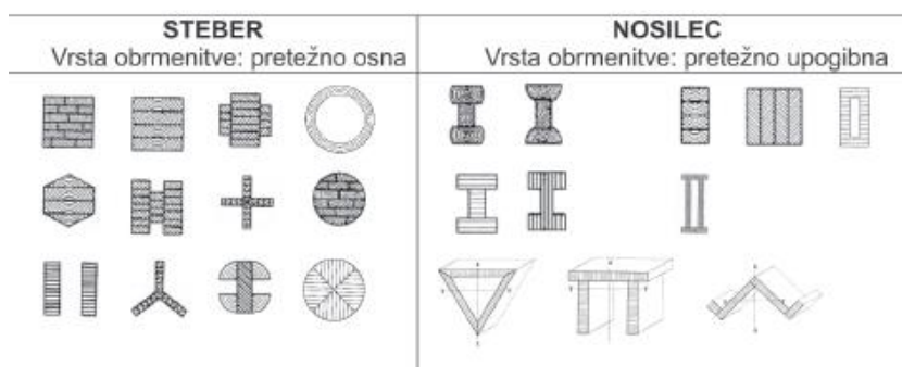
Slika 17: Prečni prerezi elementov iz lepljenega lesa [12].
