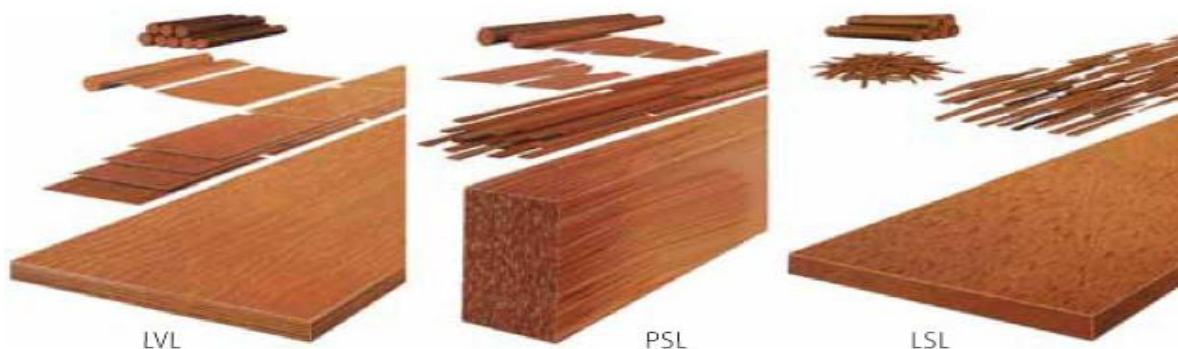
Slika 4: Shematska predstavitev vrst konstrukcijskega kompozitnega lesa [11].
