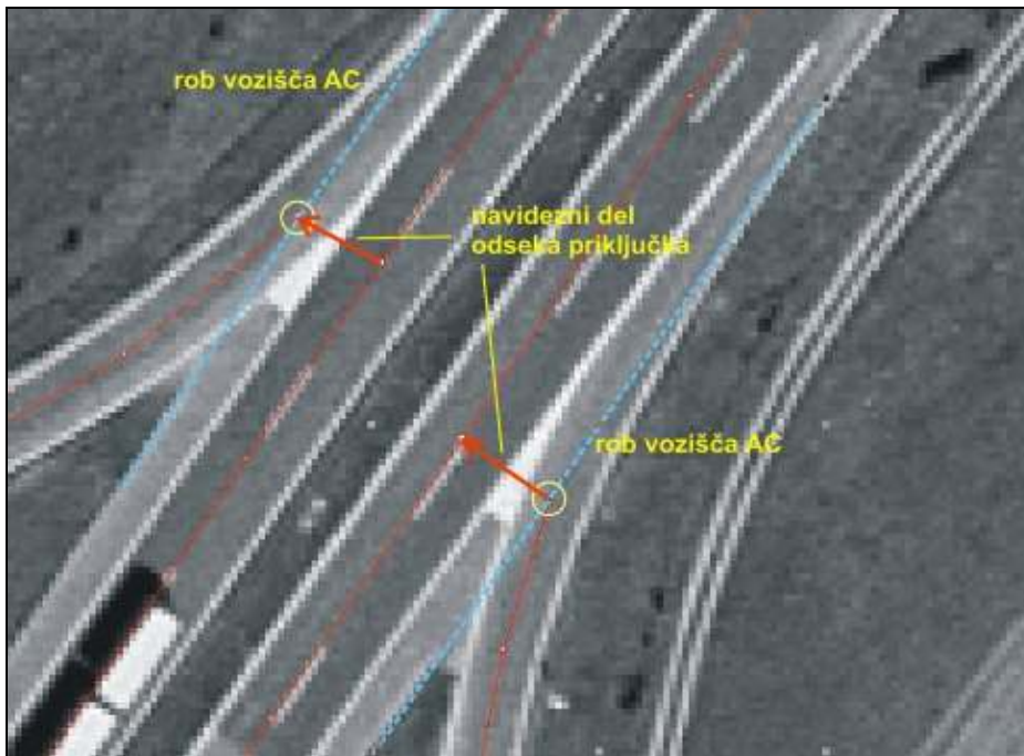
Slika 4: Navidezni del priključka AC ali HC (DRSC, Metodologija ..., marec 2007)
